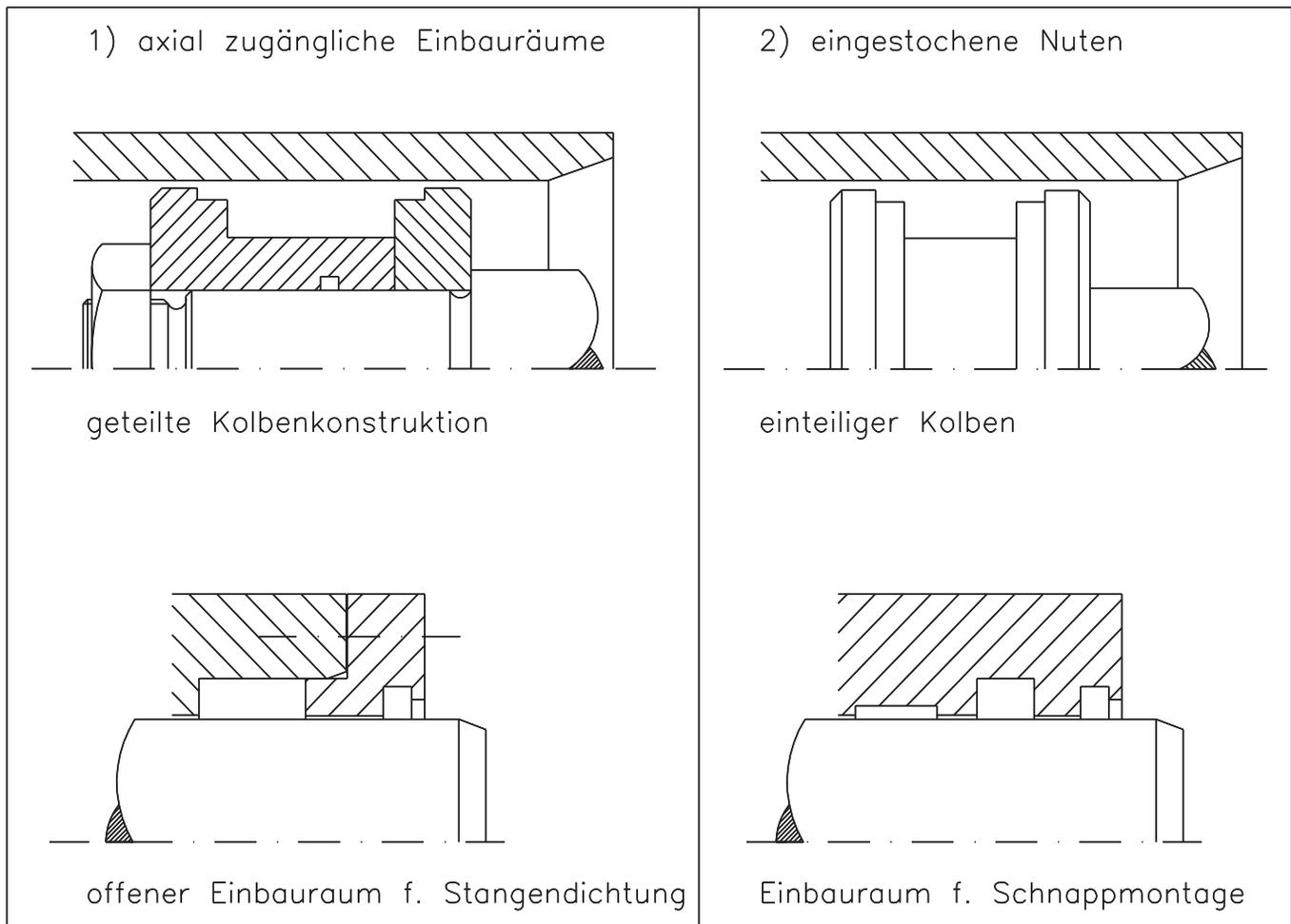
Einige Dichtelemente wie z.B. Dachmanschetten-Dichtsätze oder gewebearmierte Dichtungen mit großem Dichtungsquerschnitt benötigen zur Montage grundsätzlich axial zugängliche Einbauräume. Die meisten HME-Dichtungen können jedoch in eingestochene Nuten montiert werden. Zur Montage bei kleinen Durchmessern sind jedoch auch hier axial zugängliche Einbauräume erforderlich.
