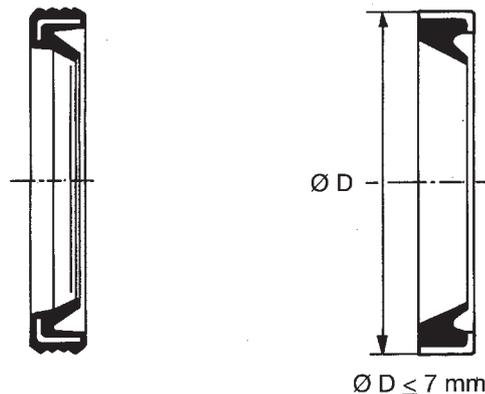
Standardmäßige DINA-Ring-Werkstoffe sind NBR-Elastomer und Karbonstahleinsatz.
