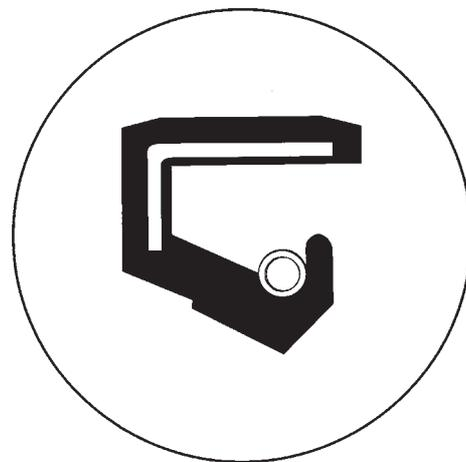
Werkstoff : Gummielastomer/Metall-Verbindung
