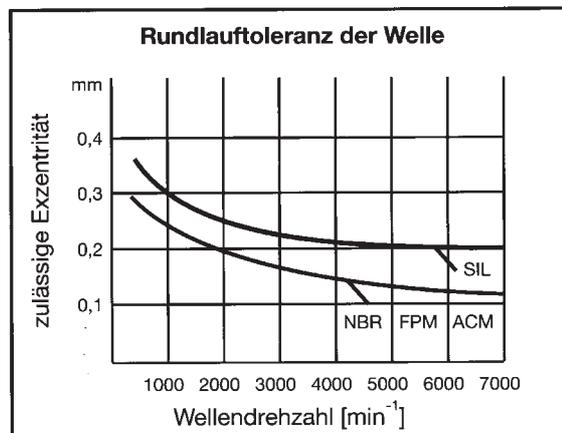
Die Unrundheit zwischen Welle und Gehäusebohrung muß möglichst klein gehalten werden, um einseitige Belastung (Verschleiß) der Dichtlippe weitgehend zu reduzieren.
