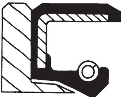
Speziell entwickelte Radialwellendichtungen (P-Typen) sind hier vorzuziehen, selbst wenn eine sorgfältigere Montage und eine geringere Rundlaufabweichung der Welle erforderlich sind als im Normalfall.
