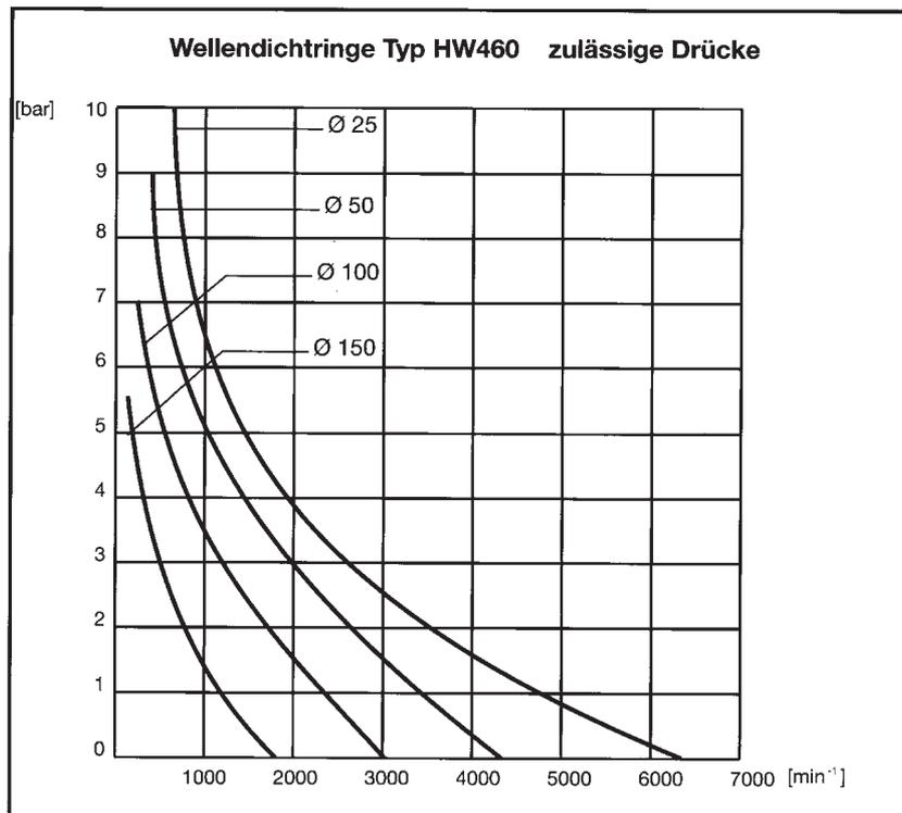
Auf Anfrage können wir Wellendichtringe liefern, die eine speziell verstärkte Dichtlippe haben, so dass diese auch Drücke über dem angegebenen Wert standhalten.
